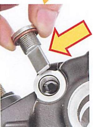
PARAFUSO DE FIXAÇÃO DO EIXO DO BALANCIM
